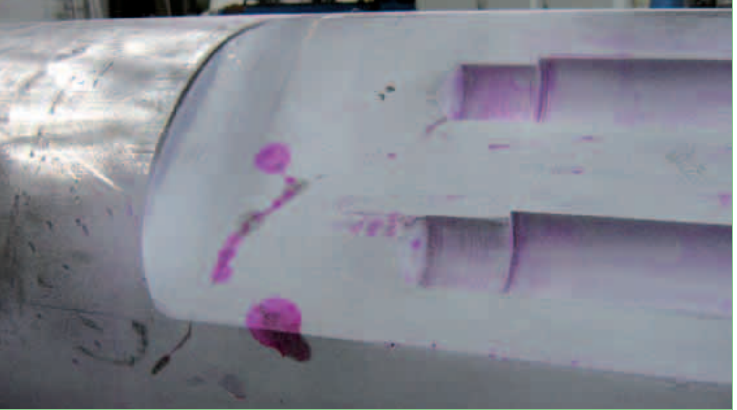
Gerissener Vierkant einer 10 MN Eumuco Exzenterwelle
