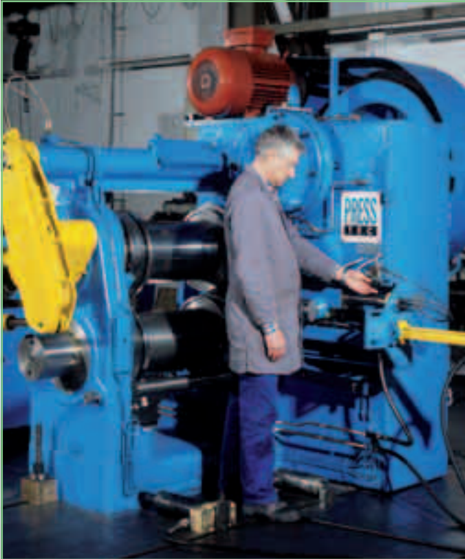
Komplett-Tuning einer automatisierten Reckwalze
