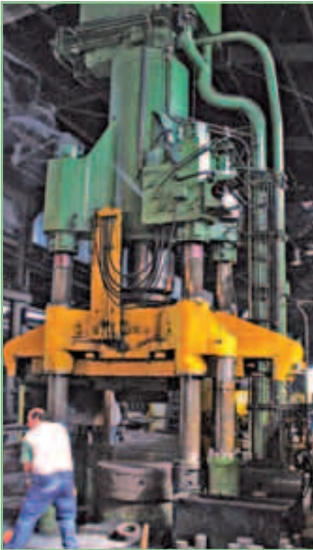
Eine Säule wurde erneuert und die Presse an den Rückzugszylindern mit neuster Dichtungstechnik versehen
