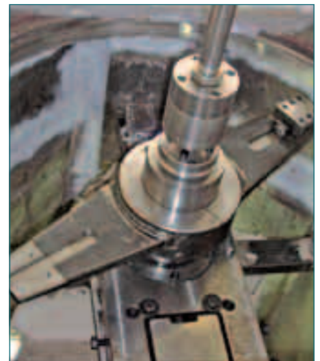
Mobile Bearbeitung der Zylinderaufnahme im Pressenkopf.
