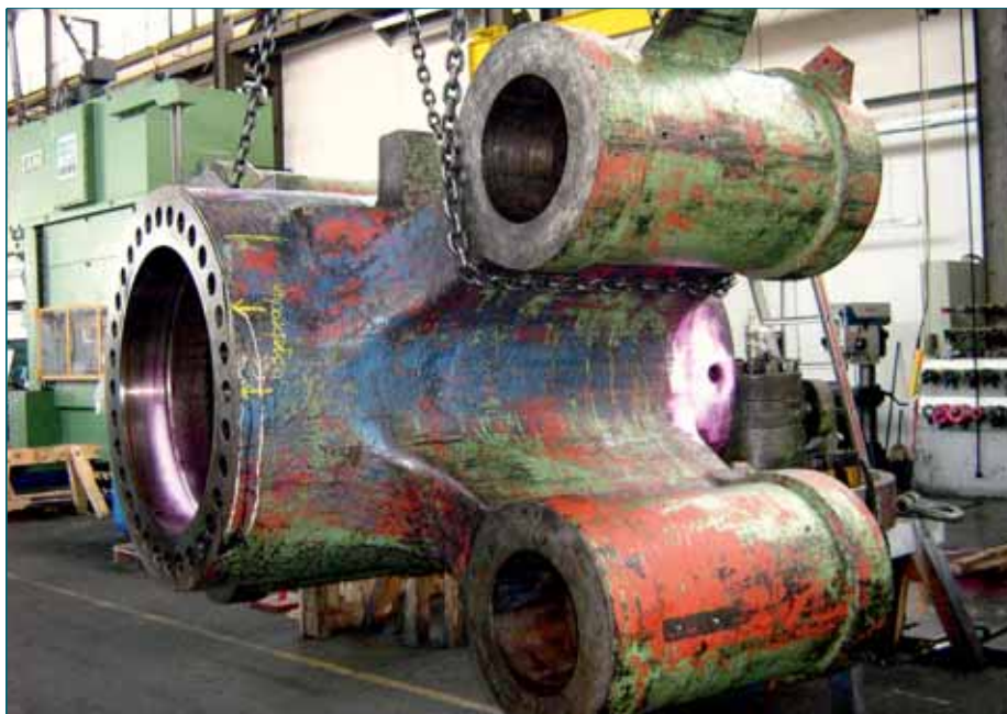
Beschädigtes Kopfstück vor der mechanischen Bearbeitung.
