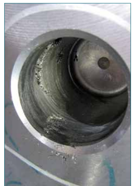
Kernlochbohrung für Gewinde im alten Kopfstück mit Fehlstellen im Guss.
