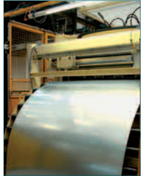
Vom Richten in die Schlaufengrube
