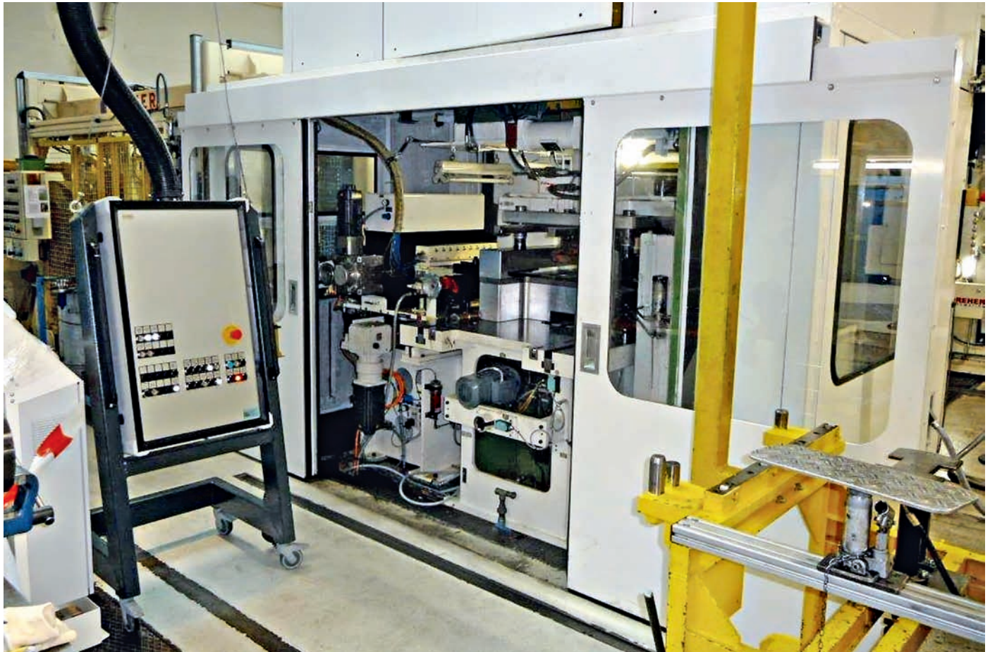
Bandanlage mit Zick-Zack-Vorschubrichtmaschine und Schnittstößel.
